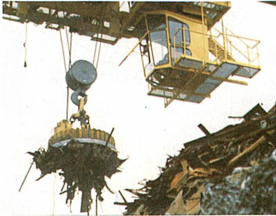
54.2 Ein Topfmagnet auf einem Schrottlagerplatz
